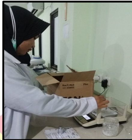
Gambar 1. Proses penimbangan garam NaCl untuk membuat larutan NaCl jenuh
