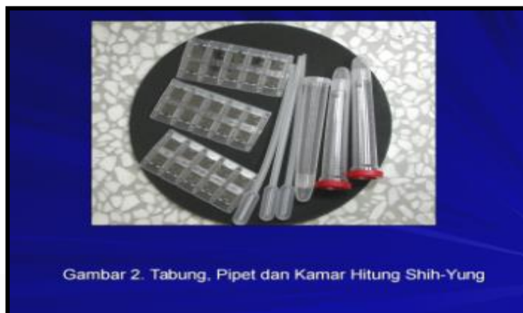
Gambar 2.22 Tabung, Pipet dan Kamar hitung Shih-Yung
