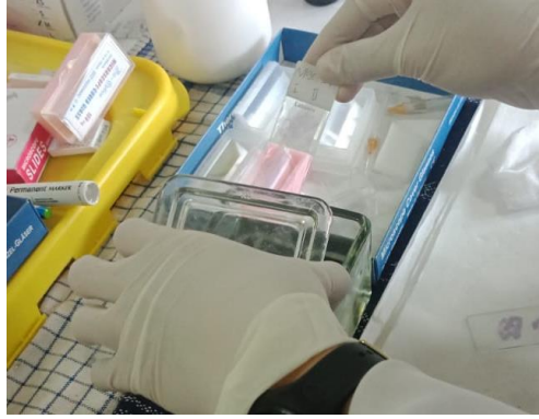
Gambar 19. Sediaan dicelupkan kedalam larutan xylol
