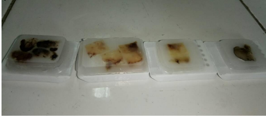
Gambar 13. Hasil peotong kasar menggunakan alat Mikrotom
