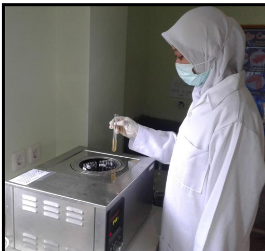
Gambar 4 Memasukkan tabung yang berisi air jagung manis rebus yang telah dicampur dengan reagen tes kit siklamat kedalam waterbath
