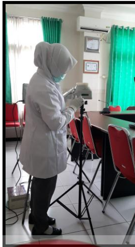
Gambar 11. Pengambilan sampel angka kuman pada alat MAS
