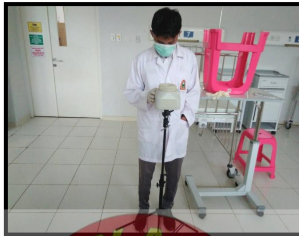
Gambar 1. Pengambilan sampel Udara pada ruang dapur ruang instalasi gizi
