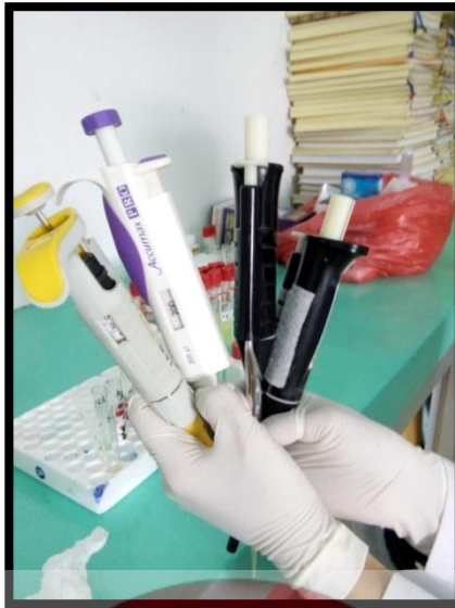
Gambar 4 : Mikropipet 1000 \mu l, 250 \mu l, 10 \mu l
