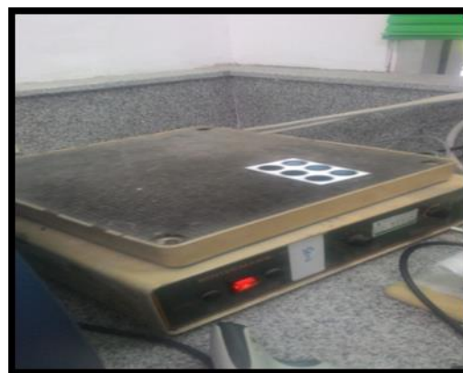
Gambar 4.3 Pembentukan aglutinasi dengan menggunakan rotator
