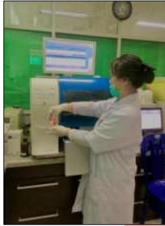
Gambar 4. dilakukan scan barcode pada alat stago compact max 2
