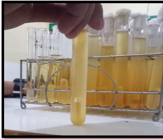
Gambar 4. Hasil Tabung LTB positif keruh dan terdapat gas
