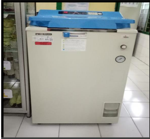
Gambar 10. Autoklaf, untuk sterilisasi media.
