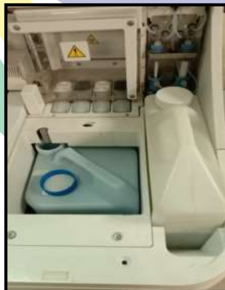
Gambar 6 Wadah penampung limbah cair disebelah kiri dan wadah penampung aquadest untuk pencucian disebelah kanan pada alat Cobas E-411
