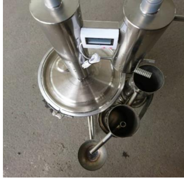
Gambar 2. 2. Penyulingan Dengan Uap
