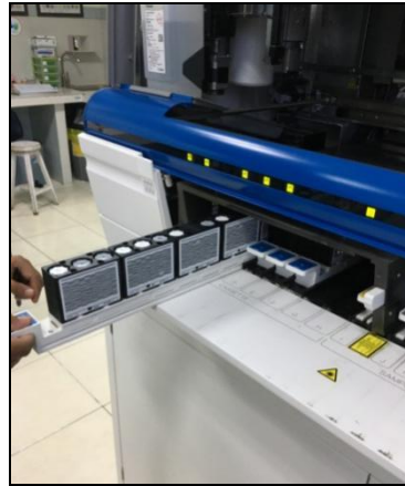
Gambar 9. Proses memasukan Rak reagen ke dalam alat Cobas Integra 400 Plus
