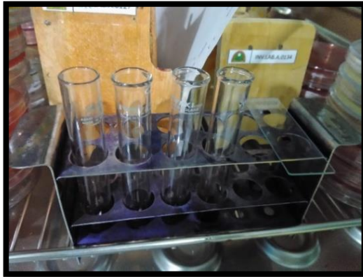
Gambar 4. Dokumentasi Slide dan Tabung saat diinkubasi selama 30 detik
