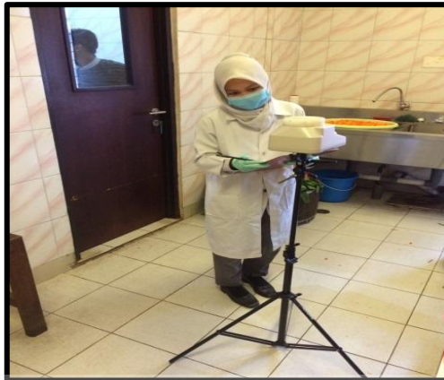
Gambar 1. Pengambilan sampel Angka Kuman Udara Diruang persiapan sayur
