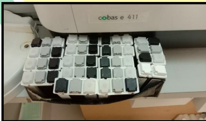
Gambar 3. Reagen untuk semua pemeriksaan pada alat Cobas E 411
