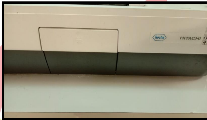
Gambar 5. Tempat penampungan Limbah tip pada alat Cobas E 411
