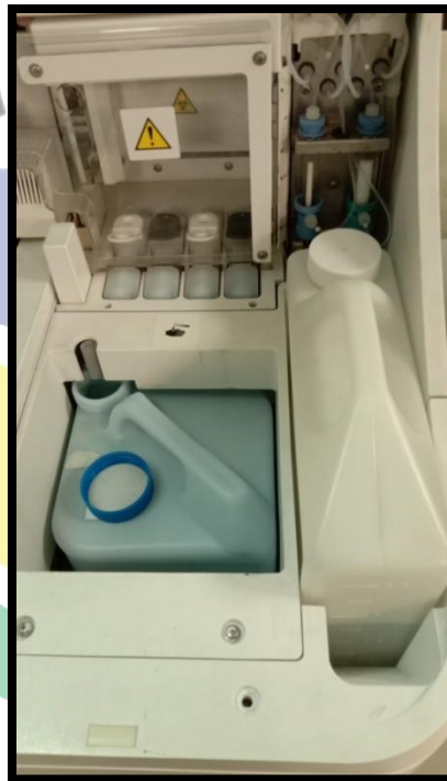
Gambar 9. Wadah Penampung Limbah Cair disebelah kiri Lalu wadah air aquades untuk pencucian disebelah kanan Pada alat Cobas E 411
