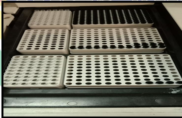
Gambar 6. Tip untuk penghisap reagen dan sampel pada alat Cobas E 411
