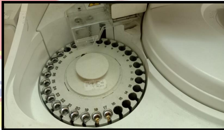
Gambar 2. Rak tempat meletakkan sampel dan reagen pada Cobas E 411
