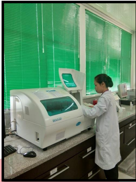
Gambar 3. Pemeriksaan LDH dan CKMB Menggunakan Alat Biolis24i Premium
