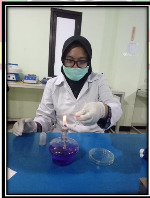
Gambar 2. Memanaskan sampel diatas lampu spirtus
